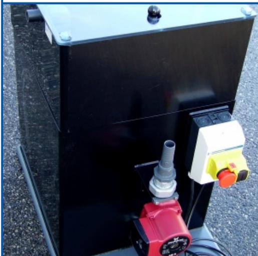
Das EX402B-Modul bietet eine geschlossene Wasserversorgung für hydraulische Experimente. Es enthält eine elektrische Pumpe und eine auf einem starren Chassis montierte Speicherpumpe.
