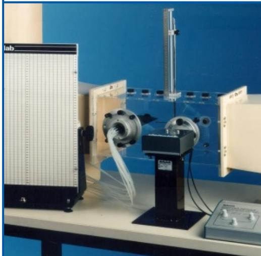
Cylindre orientable avec repérage angulaire de précision,
