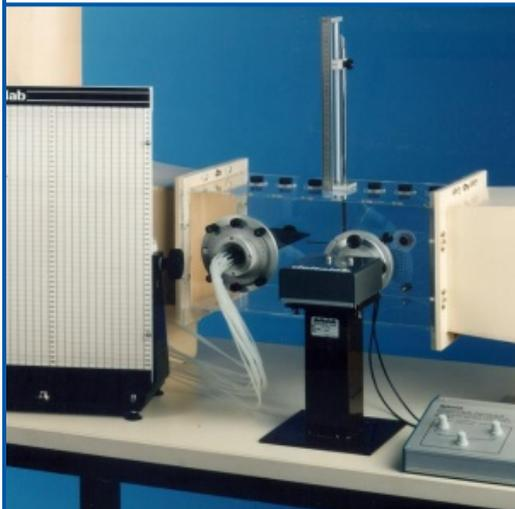
Schwenkzylinder mit präziser Winkelmarkierung, ausgestattet mit zwei Druckhähnen (Ref EA604)
