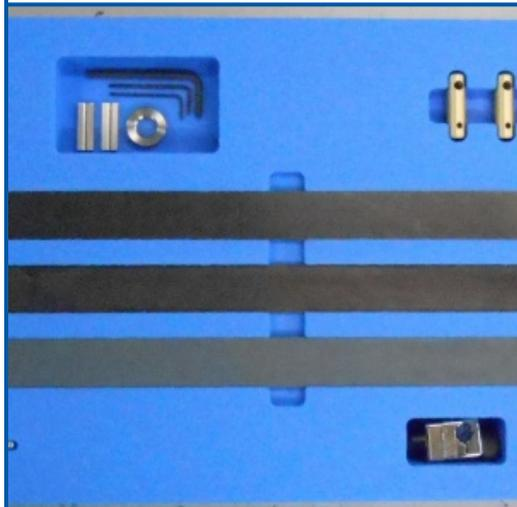
Der Knicksatz EX150C1, der die Zugbiegebank EX150 ergänzt, ermöglicht das Studium der Biegeknickung. Das System ermöglicht es, den Einfluss der Bedingungen an den Stützen auf das Beulen zu untersuchen: artikulierte oder bündige Unterstützung, zentrale Unterstützung oder Deportation. Das Kit enthält Teststücke aus verschiedenen Materialien mit unterschiedlichen Stärken für jedes Material.
