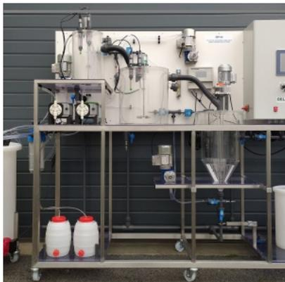
Pilote de traitement des eaux usées par boues activées, anoxie en tête, nitrification, dénitrification
